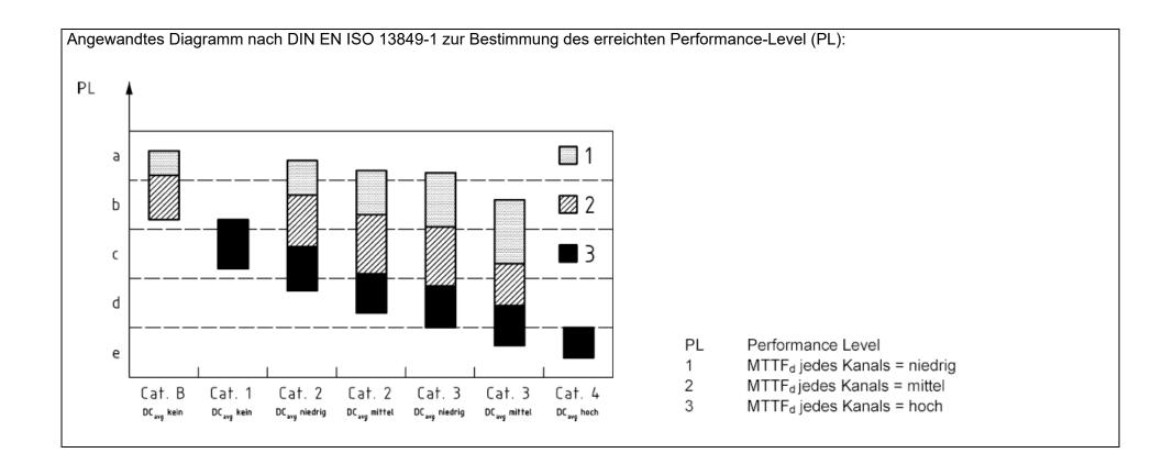
Angewandte Tabelle zur Bestimmung des erreichten PL für die gesamte Steuerung nach DIN EN ISO 13849-1:
